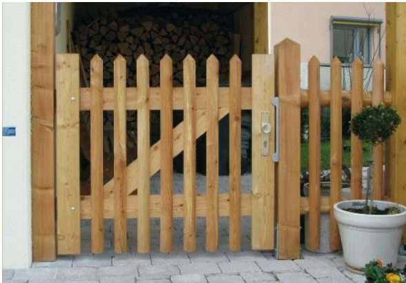
Halbrunde Staketen gefräst Spitzen oben angekegelt 6,5 cm Breit Bindestangen 95 mm stark
